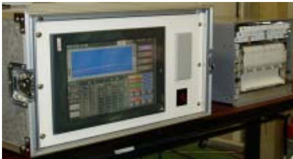
写真-1 流量比率制御装置
