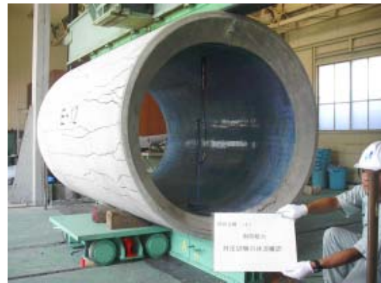
写真- 5 外圧試験状況（円形）
