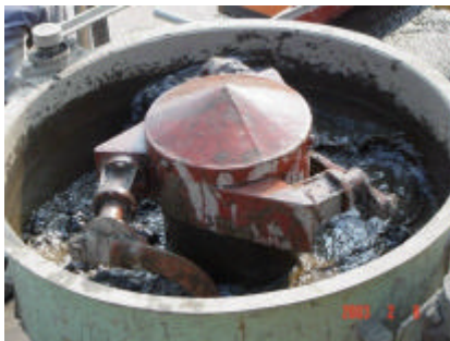
写真- 5 攪拌工程
