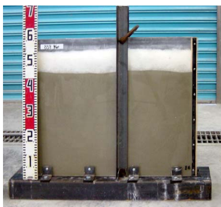
写真-3 グラウト注入試験
