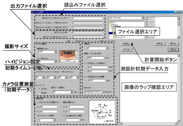
図-6 合成座標計算プログラム表示例
