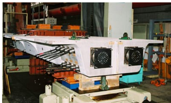
写真-6 一般部曲げせん断実験
