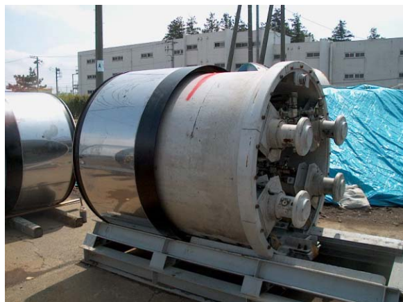
写真－4 R C更生管と推進装置
