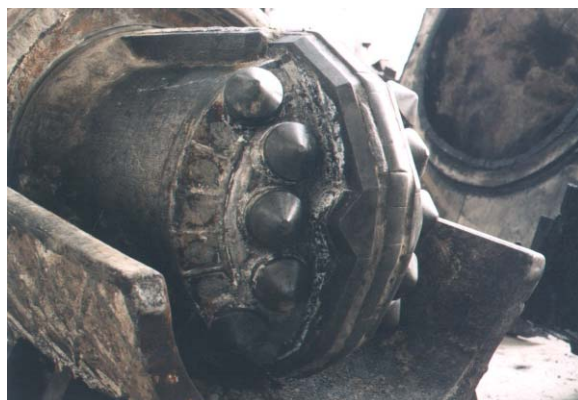
写真－６ 掘進を終えたオーバカッタ先端部
