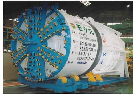
写真-2 リレービットを搭載したシールド掘削機
