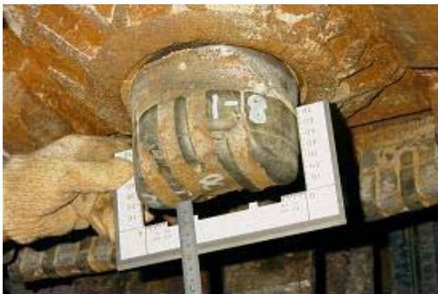
写真-4 リレー先行ビットの摩耗確認状況
