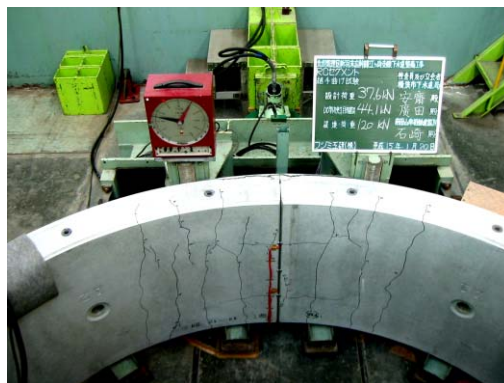
写真-7 CASE-2 ひび割れ発生状況
