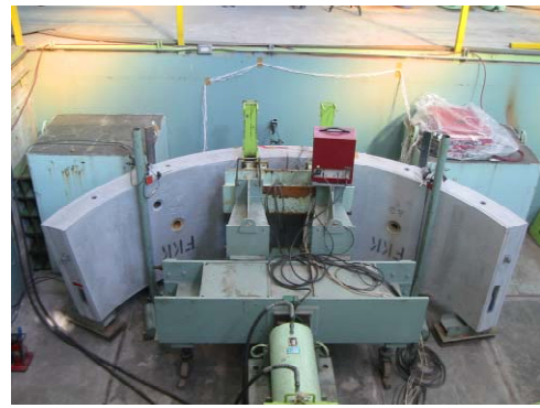
写真-8 継手負曲げ試験状況
