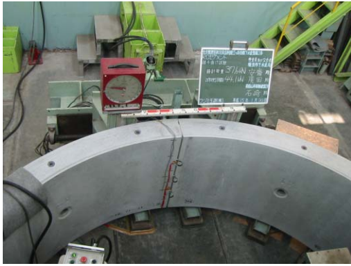
写真-4 継手正曲げ試験状況
