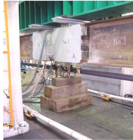
写真-2 実物大曲げ載荷試験
