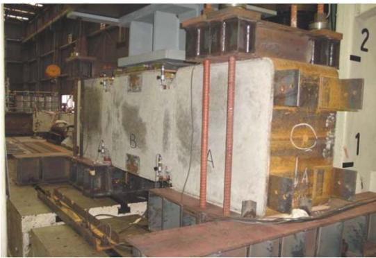
写真-3 実物大せん断載荷試験
