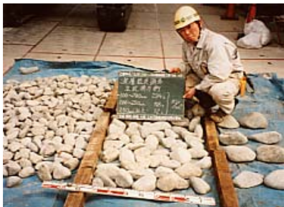
写真-3 東京礫層の礫径調査状況
