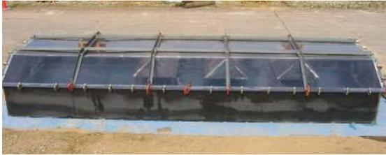
写真- 2 二次覆工模擬型枠
