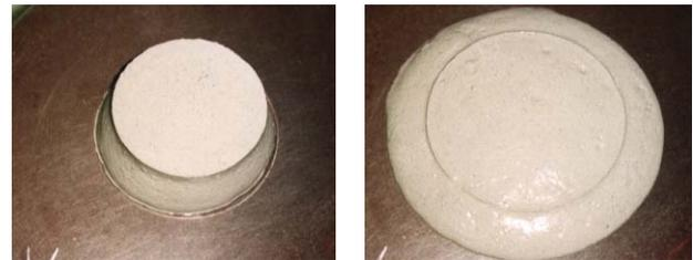
フローコーン引抜き後 (自立状態)      15回振動後 (流動状態)
