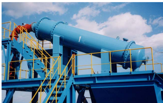
写真-2 最大クラスのソイルセパレータ （泥水処理能力 1,785\sim 2,895\text{m}^3/\text{hr} ）
