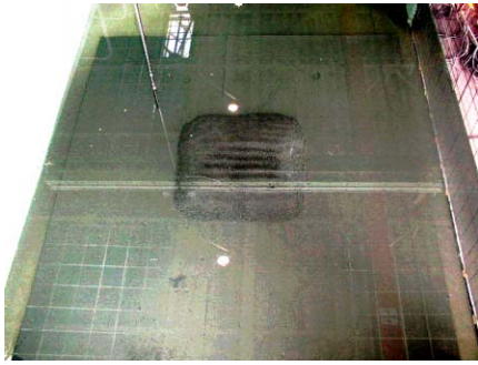
写真-10 焼却灰造粒物による覆砂状況
