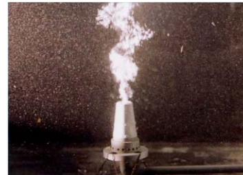
図-4 超微細気泡発生装置
