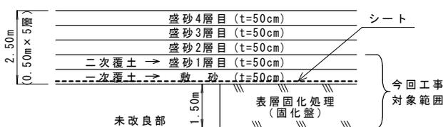
図-1 工事概要断面図
