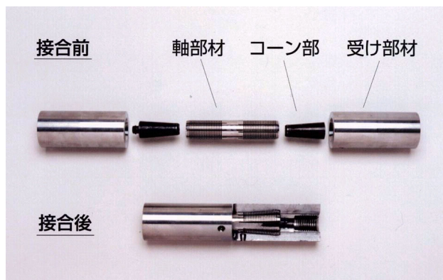
写真-1 双頭アンカー継手
