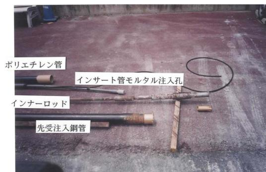
写真-1 AGF-HITM 削孔システム
