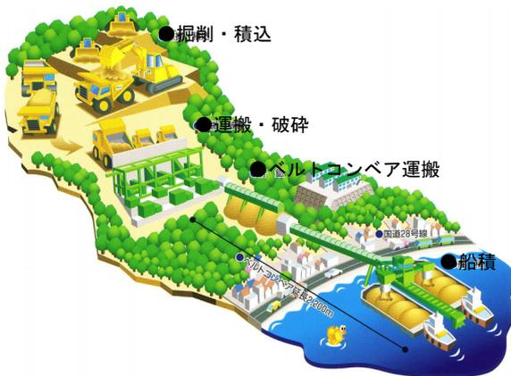
図-1 採土現場の作業概要<sup>2)</sup>
