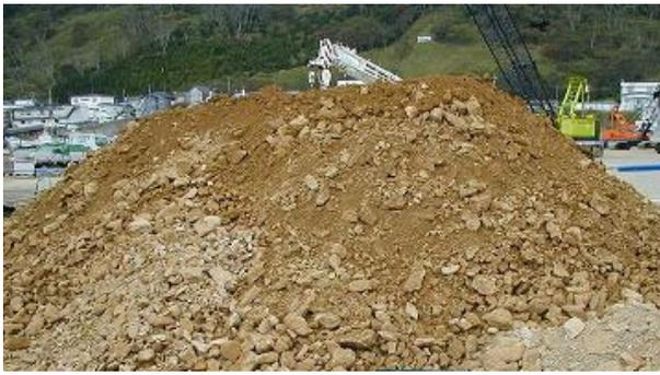
破砕前泥岩（最大粒径 200mm）
