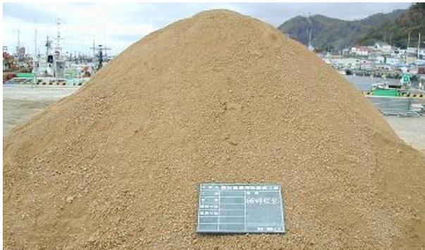
破砕後泥岩（最大粒径26mm）
