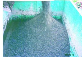
写真-2 遠心分離機による二次処理土
