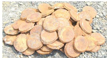
写真-4 非電食部の残存鉄片
