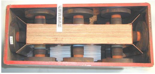
写真-2 模擬杭芯材断面写真
