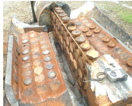
写真-3 模擬杭芯材解体状況
