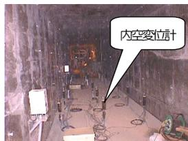
写真-4 ボックスカルバート内部計測
