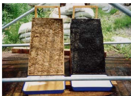
写真-6 耐侵食性試験状況
