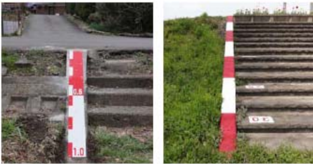
図 - 4 経験的危険個所に設置した簡易量水
