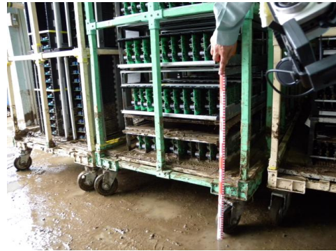
写真-3 榊平福電機製作所の浸水被害 (床上 0.5m まで浸水し、出荷前の車載用電子部品が泥をかぶっている状況、8 月 12 日著者撮影)
