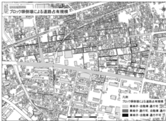
図7. ブロック塀倒壊による道路占有規模
