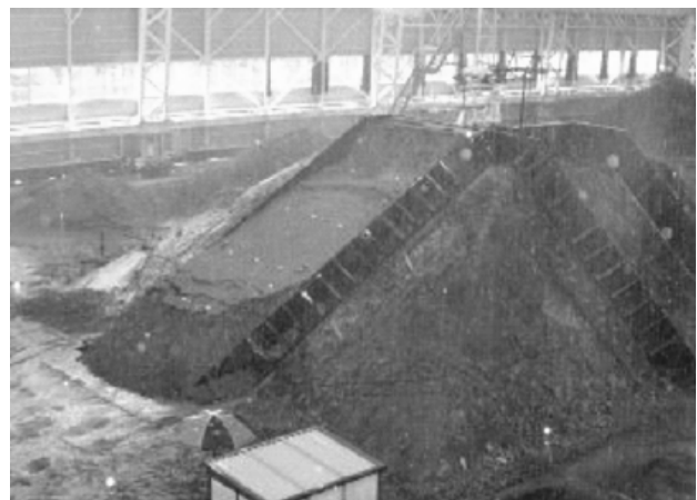
図-5 防災科学技術研究所大型降雨実験施設における斜面崩壊実験の様子
