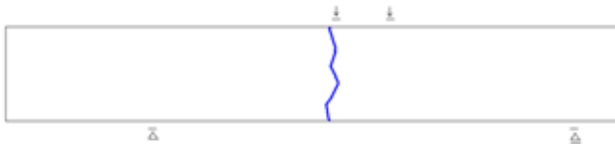
図9 消融雪管保護用コンクリートの曲げ実験の破壊
