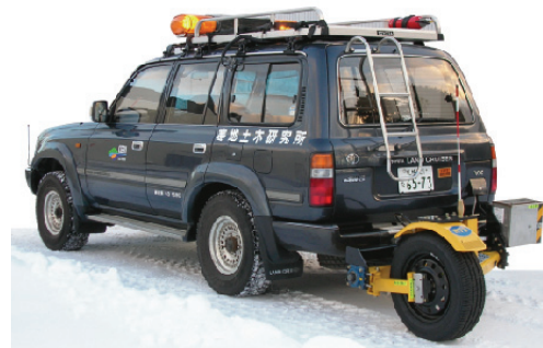
図-10 連続路面すべり抵抗値測定装置 (CFT)
