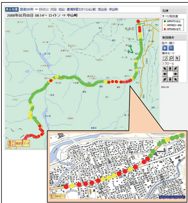
図-13 冬期路面管理支援ツール
