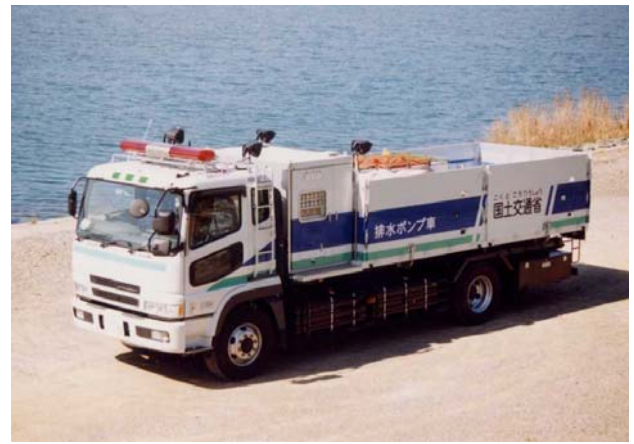
写真－６ 配水ポンプ車
