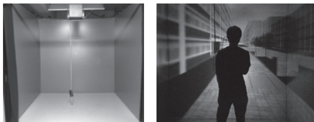
図-1 CAVE 装置【左：装置全景(正面、左右、下の4面スクリーン、中央の液晶シャッターメガネとワンド)】【右：使用時の投影の様子】
