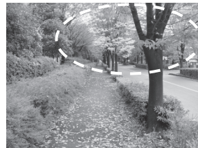
図-8 歩行者の視線を阻害している植栽の例
