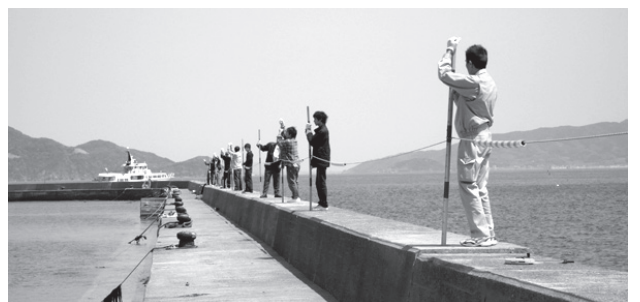
写真-1 「原案」天端高さに対する可視領域調査の様子
