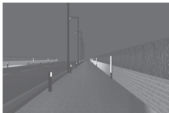
図-14 CG画像C (歩道の左側がセンサー照明、右側が補助照明)
