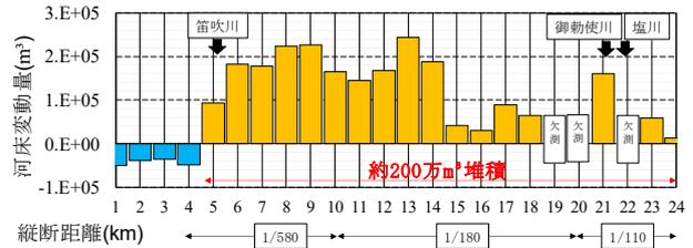
図-3 直轄区間の土砂堆積量縦断図
