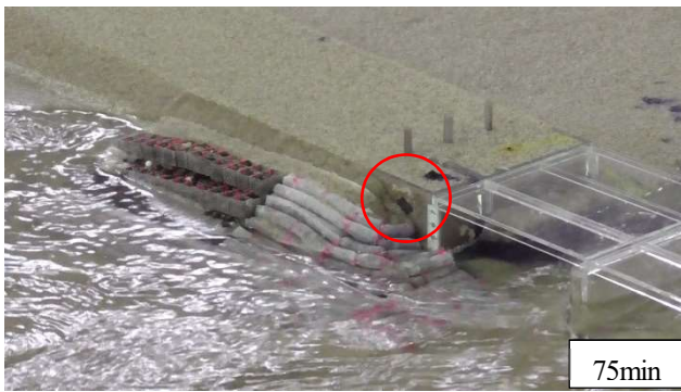
図-8 case 4 浸透状況と橋台ウイング部に出現した穴
