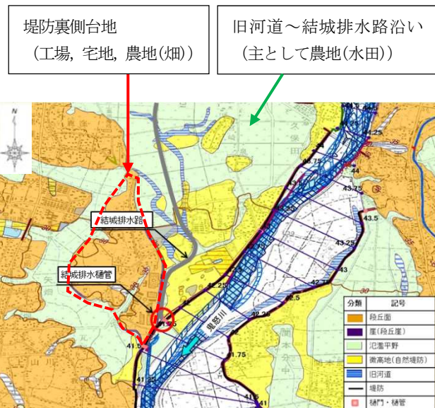
図-10 治水地形分類図と現況結城排水路の重ね図
