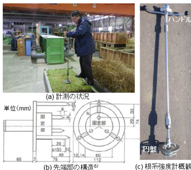
図-11 ペン式根系強度計
