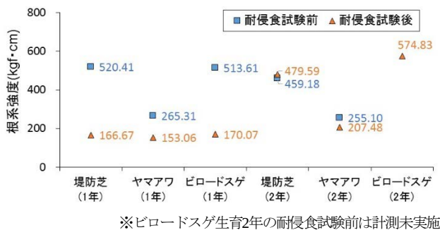
図-12 ベーン式根系強度計による根系強度
