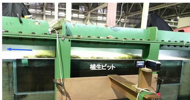
図-4 耐侵食試験装置（高速循環水路）
