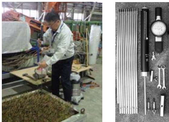
(a) 土検棒による測定状況 (b) 機器の全体構成 9) 図-13 土検棒による土壌硬度の測定
