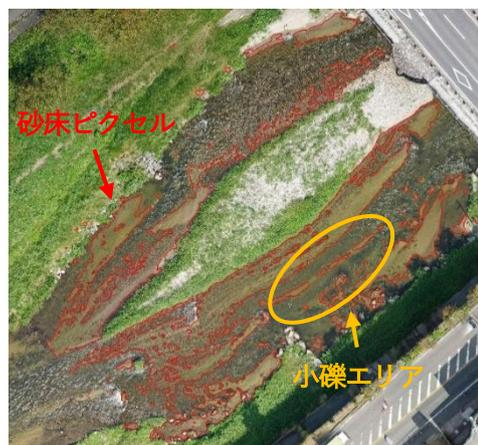
図-6 画像処理による覆砂エリアの抽出
