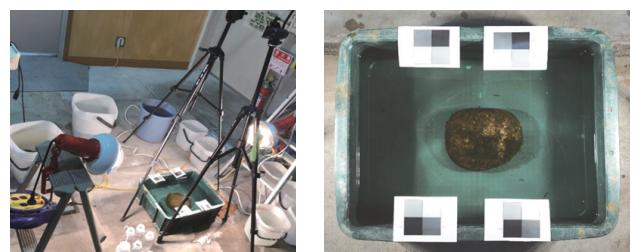
図-6 実験中の NDVI および可視光画像の撮影状況（左）と撮影された可視光画像の例（右）
