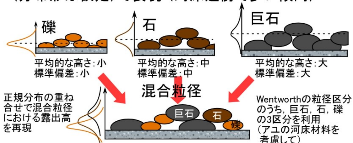
図-1 石礫の露出高の分布形を簡易的に予測するモデルの概要. 宮川ほか (2018) 7) を基に作図
