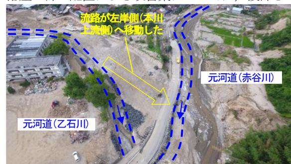
図-1 被災後の乙石川合流点の状況
