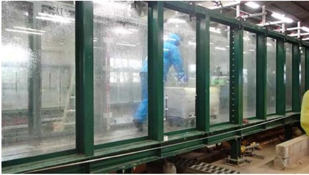
図-3 人工降雨装置と実験の様子
