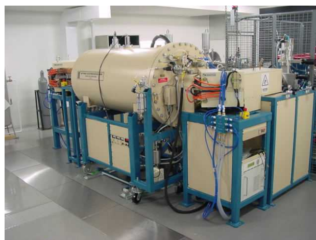
写真-2 AMS法で使用した測定機器 イオンを高エネルギーで加速させ、質量分析を行う
