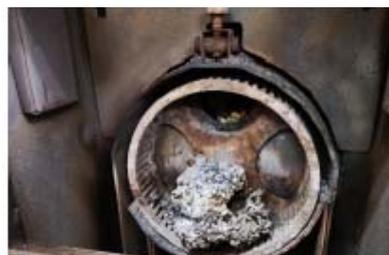
図-4 回転燃焼ポット内の固結した燃焼灰
