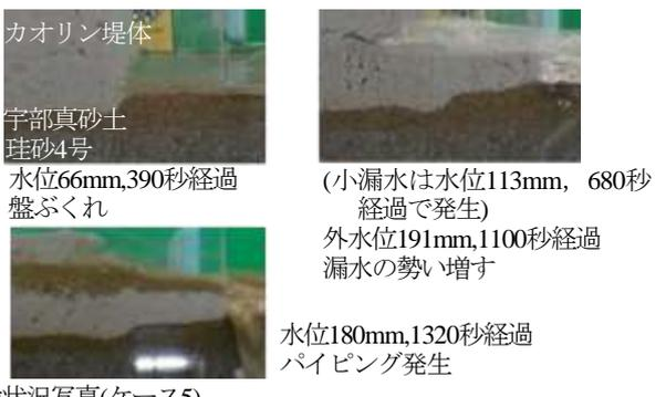
なくなった。6300秒後の同水位で再び水みちが発生し、7815秒後の水位140mmで給水槽の外水がカオリン堤体の高さを超え、越水に至ったため実験終了した。堤体直下の圧力水頭は給水槽からの距離に従って減衰している。
