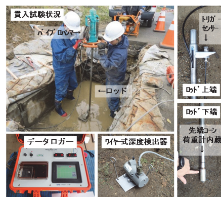
図-6 パイプロコーン試験装置の様子
