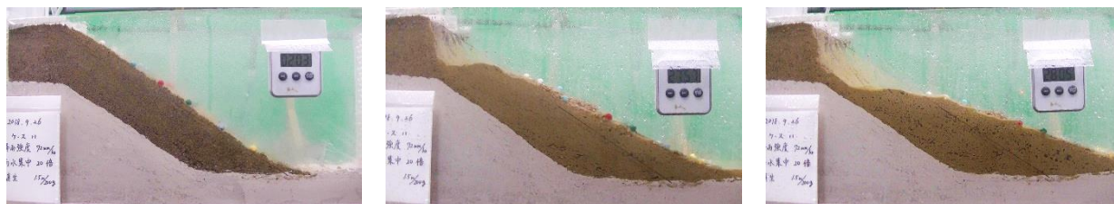
図-15 実験Aの典型的なすべり（左から順に実験開始, すべり開始, 実験終了時）
