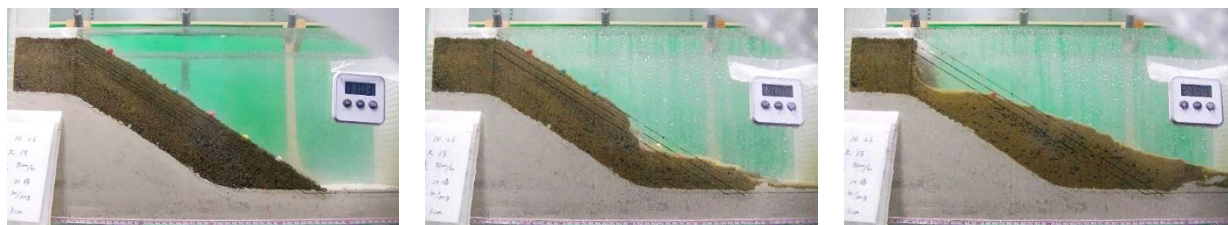
図-16 実験Bの典型的なすべり（左から順に実験開始, すべり開始, 実験終了時）
